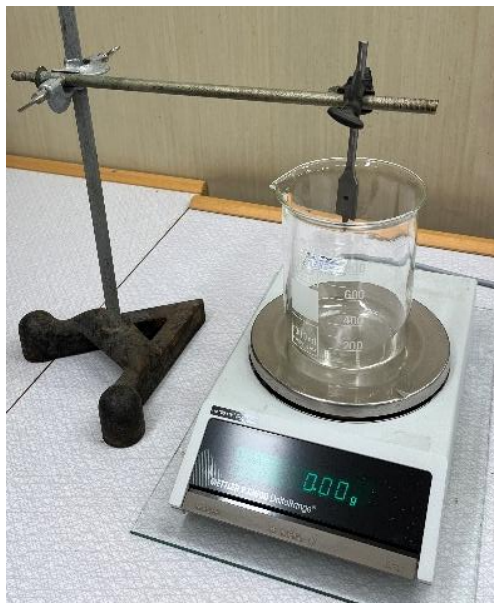
Figur 8. Utrustning för att mäta trissornas volym. Kärlet fylldes med vatten och vågen nollställdes. Därefter placerades trissan i vattnet och trycktes ned med ett spetsigt föremål så att den precis täcktes med vatten. Därefter avlästes vågen. Foto: Eva Persson
