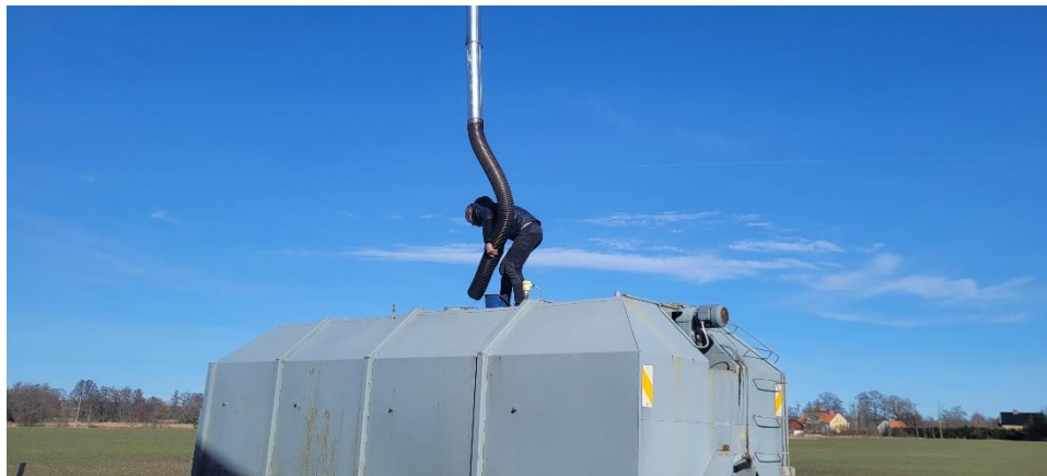
Figur 7. Exempel på täckt krokväxlarflak. Vid en permanent anläggning lastas biokolet lämpligen med hjälp av en skruv.
