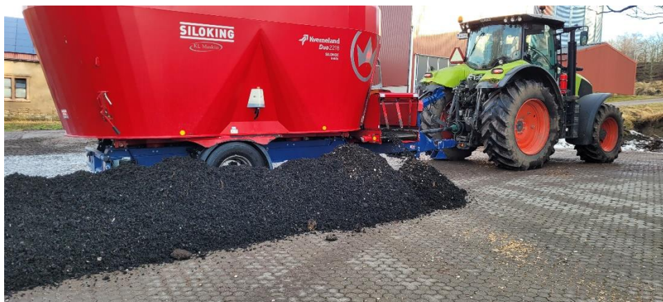
Figur 5. En foderblandare, exempel på typ enligt bilden, föreslås för blandning av slam och träflis före torkning.
