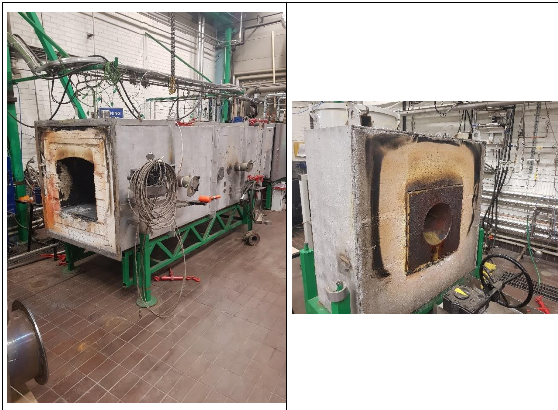
Figur 5. Vänster: Keramiskt infodrad ugn med brännargaveln borttagen. Höger: Brännargavel sedd från sidan som är vänd in mot ugnen.
