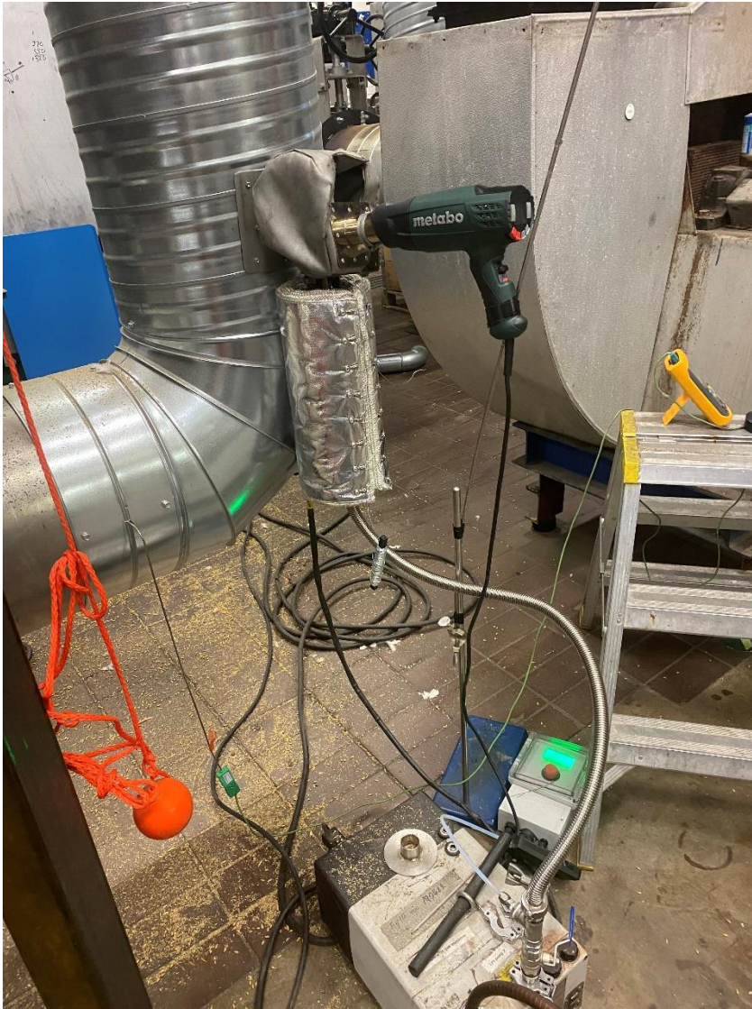
Figur 9. Impaktorprovtagningen i de 80 gradiga rökgaserna uppströms torken.
